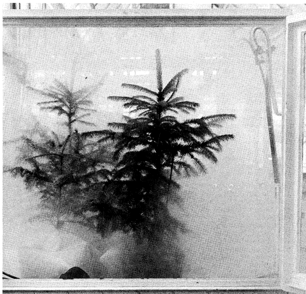
Versuch mit „Sauerm Nebel“ in der Nebelkammer an der Landesanstalt für Immissionsschutz in Essen Foto: Thomas Pflaum
